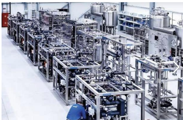
Obr.4.8. Výrobní linka na výrobu skidů
