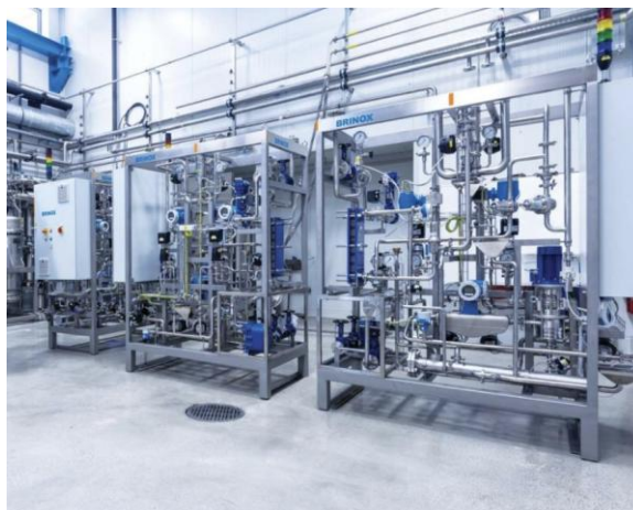
Obr.4.9. Spojení skidů do výrobní linky
